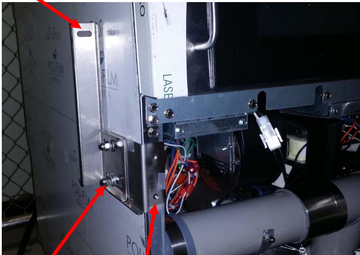
ステップ4: 場所が見つかりました。ブラケットがキャビネット側に搭載され、0.145径穴をドリルされます。マーク。所定の位置にブラケットをネジに付属のキャビネットのネジを使用。
